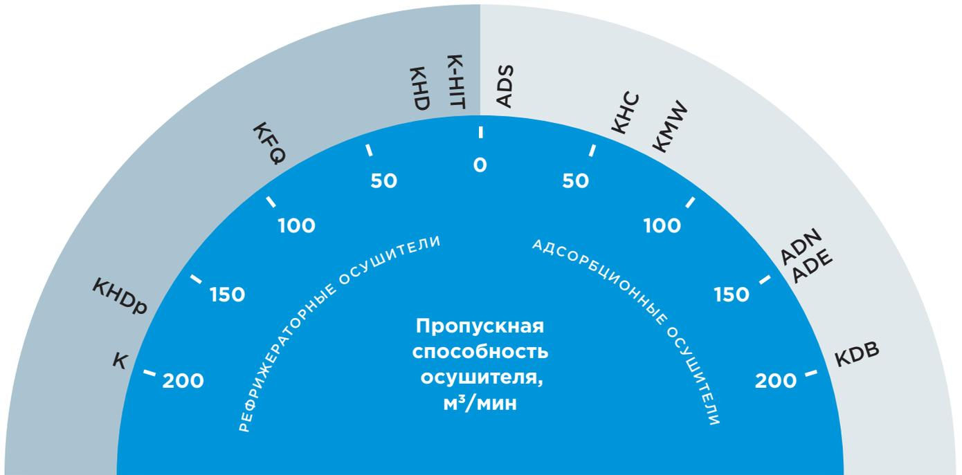
Одним из основных параметров осушителя является его пропускная способность. В таблицах параметров приведены показатели пропускной способности осушителей при давлении 7 бар и температуре сжатого воздуха 35 °С. Если условия работы осушителя отличаются от стандартных, то пропускная способность осушителя будет скорректирована.
