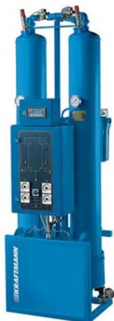
Адсорбционный осушитель горячей регенерации. Используется внутренняя система прогрева колонн, при которой потребляется всего 2-3% сжатого воздуха для регенерации. Достигают точки росы  $-40^{\circ}\text{C}$ .
