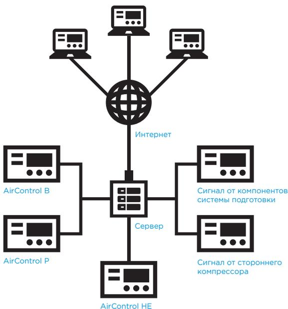
Интеллектуальные системы управления содействуют эффективному управлению компрессорами, выполняя все функции контроля и протоколирования. Это имеет большое значение для снижения затрат, повышения доступности и эксплуатационной безопасности как отдельных компрессоров, так и сети компрессоров.
