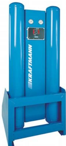
Оснащенные активированным оксидом алюминия, данные осушители в стандартном режиме обеспечивают точку росы  $-40^{\circ}\text{C}$ . При этом осушитель оснащен электронным блоком управления, позволяющим изменять продолжительность цикла осушения и достигать точки росы от  $+3$  до  $-70^{\circ}\text{C}$ . В качестве опции для данных осушителей доступен блок управления второго уровня.
