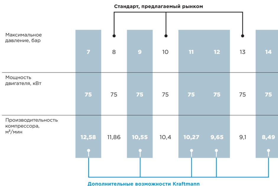
Начиная с модели VEGA 38, Kraftmann предлагает широкий выбор моделей с максимальным давлением компрессора с шагом в 1 бар, в то время как стандартный рынок компрессоров с ременным приводом ограничивается узким диапазоном.
