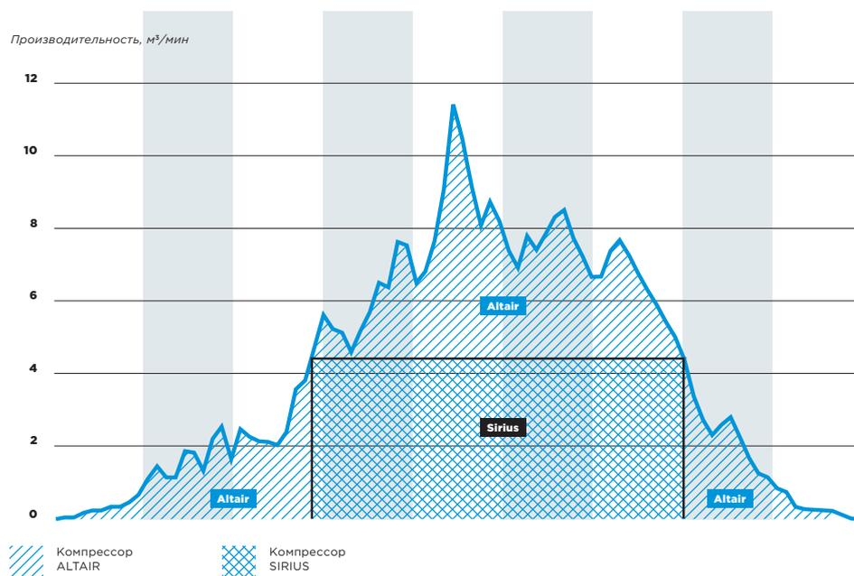
*SIRIUS + ALTAIR образуют сверхэкономичный дуэт. При такой комбинации SIRIUS выдает тот объем воздуха, который требуется на производстве постоянно, а ALTAIR дополняет его при пиковых нагрузках и обеспечивает плавный пуск всей системы.*
