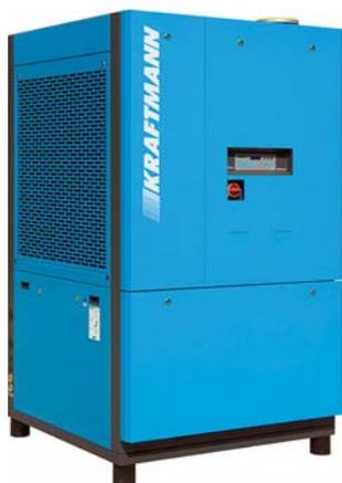
Осушители Kraftmann серии KFQ оснащены частотным преобразователем, давление и температура хладагента в них являются контрольными показателями для контроля скорости компрессора в осушителе, тем самым достигается оптимальное потребление энергии. Позволяют достичь экономии затрат на электроэнергию до 70%.
