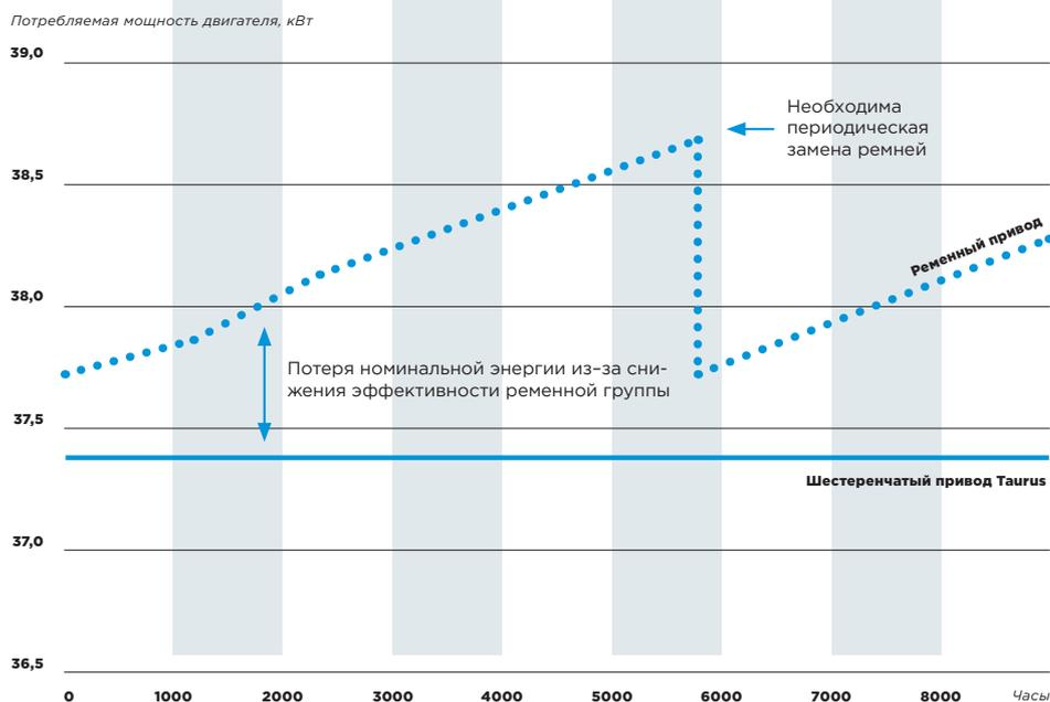
Конструкция привода обладает высокими эксплуатационными характеристиками. КПД составляет более 98%.
