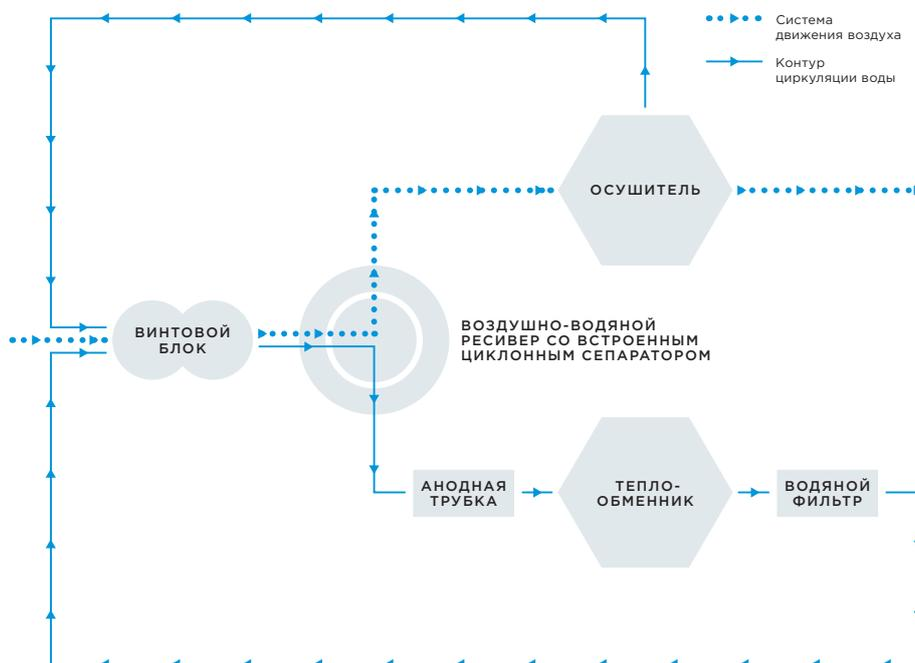
*Замкнутая и автономная система со встроенным осушителем и системой подготовки воды. Контроль за уровнем и качеством воды происходит в автоматическом режиме.*
