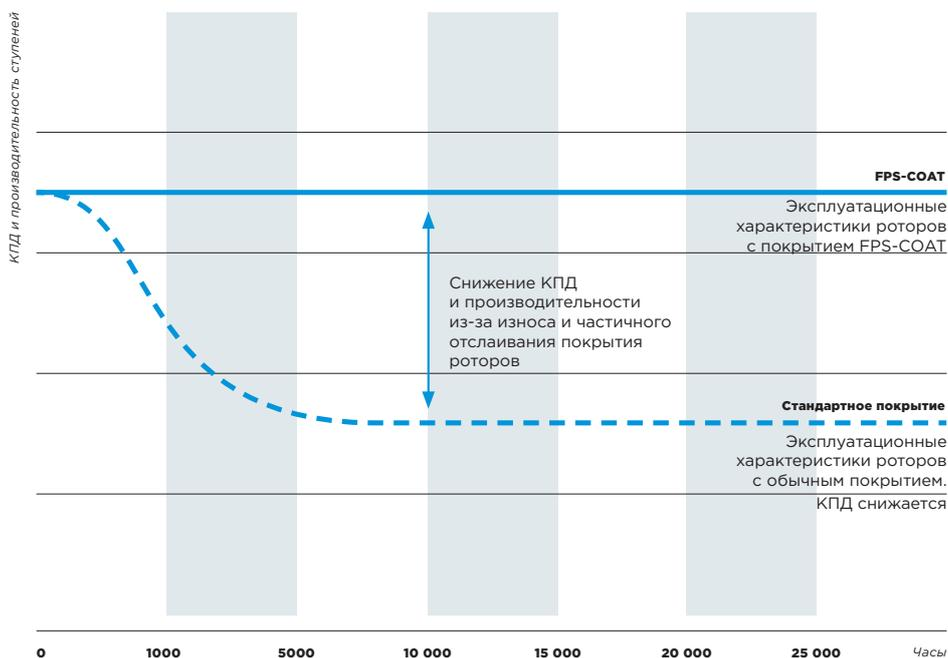
Специальное покрытие FPS-COAT обеспечивает повышенную износостойкость компрессорной головки и гарантирует постоянный КПД на протяжении многих лет при неизменно высокой производительности компрессора.
