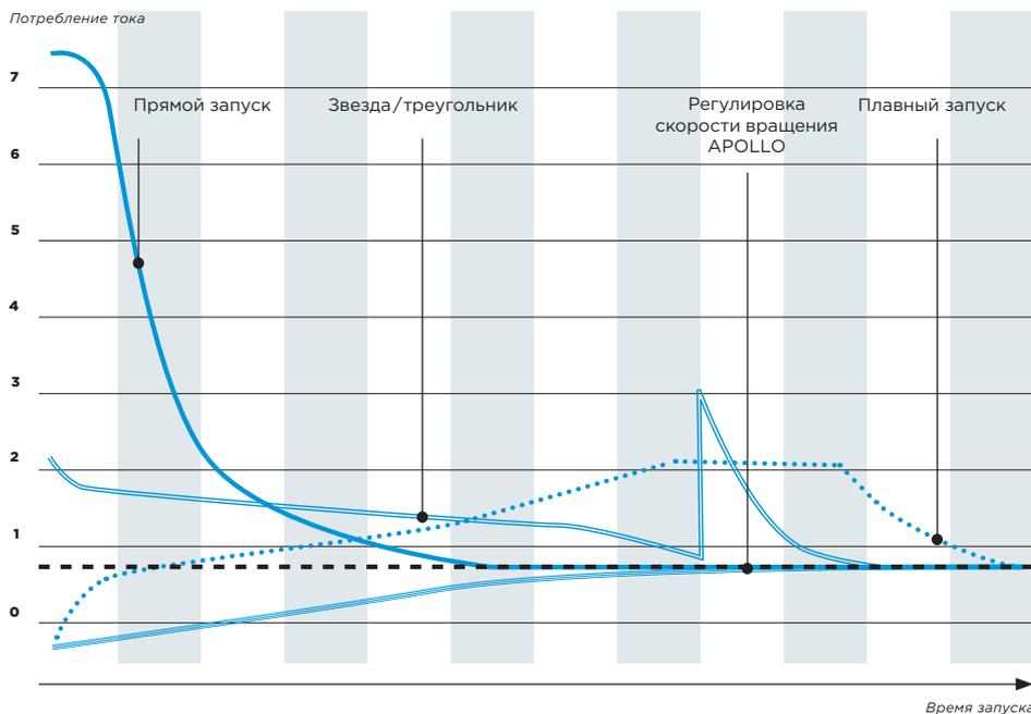
Оснащенный двигателем с регулировкой скорости вращения, компрессор APOLLO в дополнение к энергосберегающим свойствам обладает сверхплавным запуском, когда пусковой ток меньше номинального и не превышает его в несколько раз как при «прямом пуске» или запуске по схеме «звезда/треугольник». Это позволяет избежать пиковых нагрузок на сеть предприятия.
