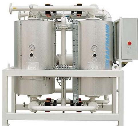
Специальная версия осушителей, в которых для десорбирования насыщенного влагой сушильного агента используется теплота сжатого воздуха. Установки КНС применяются везде, где воздух сжимается безмасляными компрессорами и на выходе имеет высокую температуру. Достигают точки росы  $-25\text{ }^{\circ}\text{C}$ .
