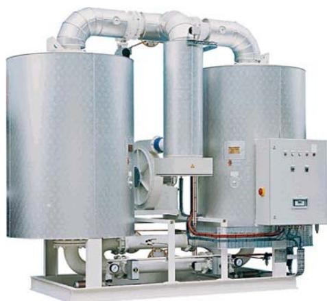
Адсорбционный осушитель горячей регенерации с внешней системой прогрева колонн, при которой практически отсутствуют потери сжатого воздуха для регенерации.
