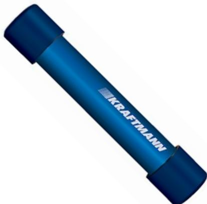
Мембранные осушители незаменимы, если пространство для установки оборудования ограничено или нет источников питания. Достигают точки росы  $-40^{\circ}\text{C}$  и требуют предварительной фильтрации воздуха с использованием фильтров KRAFTMANN серий PF и HF для сохранения мембраны в рабочем состоянии. Серия KMM — вертикального расположения, а серия KMD — горизонтального.
